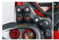
INNESTI RAPIDI POSTERIORI Impianto idraulico elettroproporzionale comandato da joystick "JPM" con doppio sistema di sicurezza operatore e centralina di comando integrata con configurazione e settaggi personalizzabili - 12 innesti rapidi posteriori.
