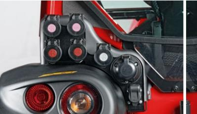
Impianto idraulico ausiliario posteriore di serie, dotato di: 2 distributori a doppio effetto (di cui 1 flottante) + 1 a semplice effetto + 1 di ritorno olio, per un totale di 6 prese idrauliche posteriori. L'impianto è ulteriormente potenziabile con altri 2 distributori a doppio effetto, un drenaggio e una mandata continua per un totale di 11 innesti rapidi posteriori.
