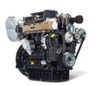
I propulsori Stage V utilizzati sono ai vertici della categoria e consentono le migliori prestazioni di coppia e potenza contestualmente a minori consumi, minore rumorosità, minori emissioni di carbonio. Trattasi di un motore Kohler a 4 cilindri (2482cc), con aspirazione turbo ed iniezione Common Rail con la potenza di 75hp a 2300 rpm e coppia massima 310 Nm a 1500 rpm.
