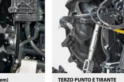
VERTICALE Ottimizza il posizionamento e l'inclinazione delle attrezzature.
