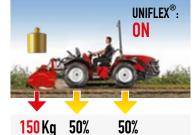
La sospensione *UNIFLEX*® trasferisce parte del peso dell'attrezzo sulle ruote.
